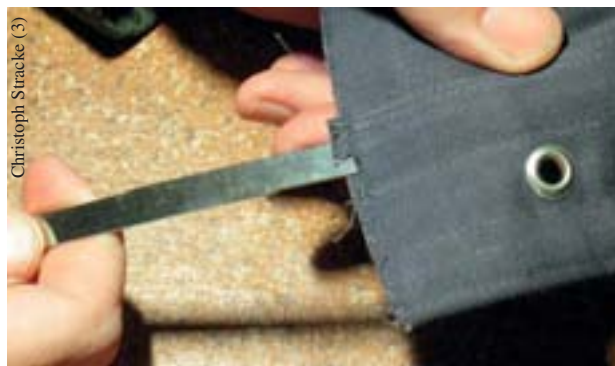
Einarbeitung der Edelstahlstäbe
